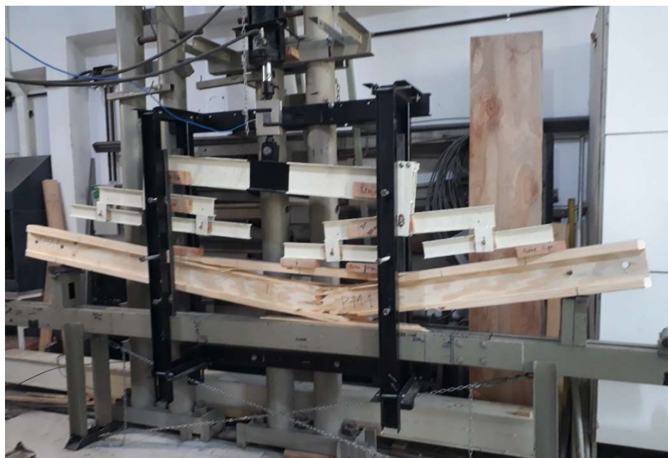
Figura 4.2 Rotura de viga por flexión
